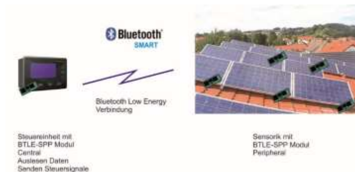
Abb. Kommunikation Steuereinheit mit Sensorik über BLE
