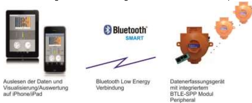
Abb. Kommunikation Smartphone mit Datenlogger über BLE
