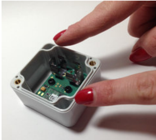
Abbildung 2 Öffnungen für Schraubbefestigung Beacon am Untergrund Bitte schließen Sie den Gehäusedeckel wieder sorgfältig.
