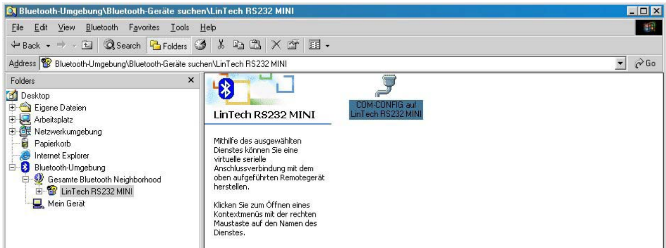
Abbildung 6 Gerätesuche mit Diensterkennung COM-CONFIG
